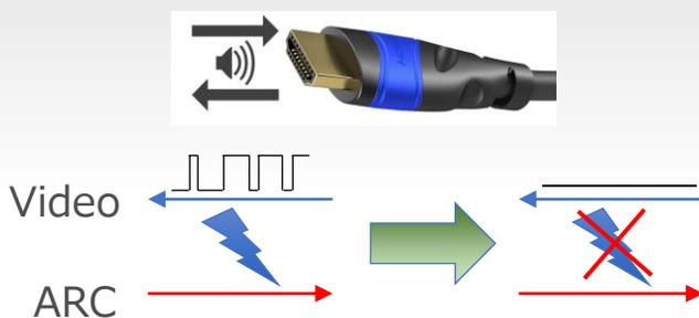
Hochfrequente ON/OFF-Schaltvorgänge des Videosignals im HDMI-Chip können Rauschen verursachen und damit das Audiosignal beeinträchtigen. Daher werden beim SU-GX70 alle Y/Cb/Cr Video-Signaldaten auf "00000000" (8-Bit-Operation) gesetzt (s. Abb. links) um Rauscheinströmungen zu verhindern und damit das Audiosignal über HDMI so rein wie möglich zu halten
