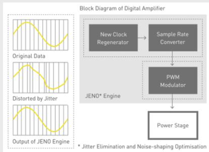
Die aus den Referenzklasse-Komponenten abgeleitete **JENO Engine** (Jitter Elimination and Noise-shaping Optimization) überträgt und verarbeitet Audiosignale mit minimalem Jitter von der Eingangs- bis zur Ausgangsstufe
