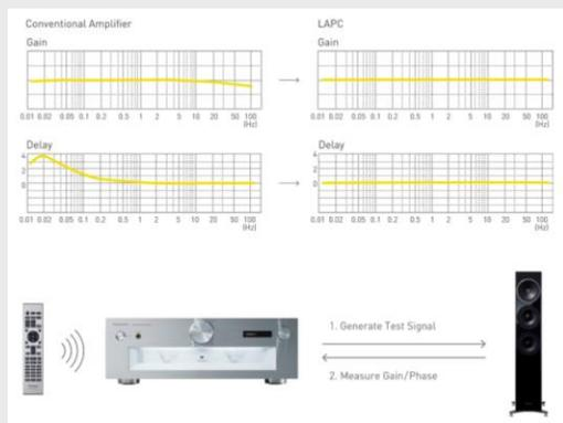
Die lastadaptive Phasenkalibrierung (LAPC) ermöglicht an jedem Lautsprecher ideale Frequenzgang- und Phasencharakteristika
